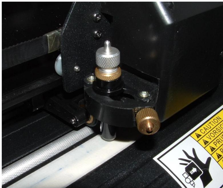
3. Schalten Sie den Plotter ein. Legen Sie Folie ein und spannen Sie diese mit dem Folienhaltern fest. Drücken Sie am Plotter die Taste Test. Der Plotter schneidet ein
